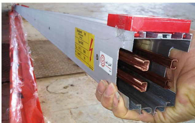
تعویض شین معیوب برق رسان جرثقیل تلمبه خانه
