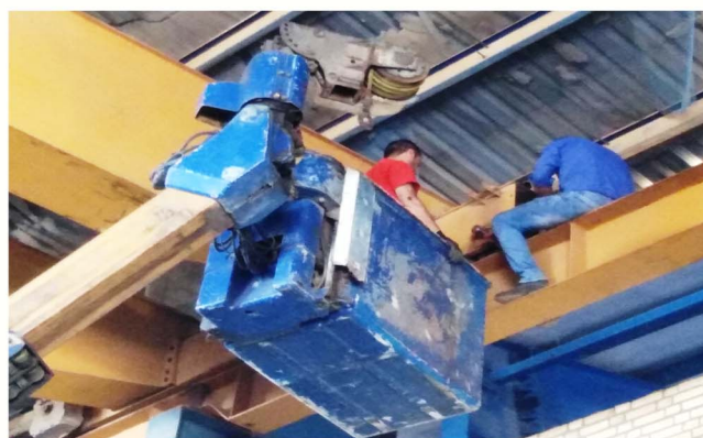
رفع اشکال و تعویض متعلقات چرخ حرکت طولی جرثقیل سه راه خرمشهر
