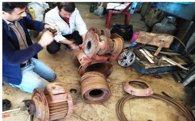
بازسازی کامل وینچ جرثقیل واقع در شهرک صنعتی شماره دو اهواز
